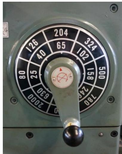
主軸速度変換レバー
